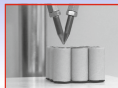
Die elektronischen Verbindungen der einzelnen Zellen werden mit einer speziellen Punktschweißmaschine hergestellt.
